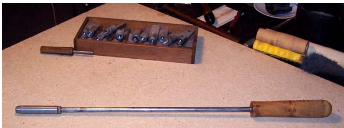
Figura 17. Alesatore per camerature cilindriche con punte di ricambio
