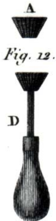
Figura 11. Fresetta per la svasatura interna dei fori, dettaglio dalla Tavola del trattato di Bergeron
