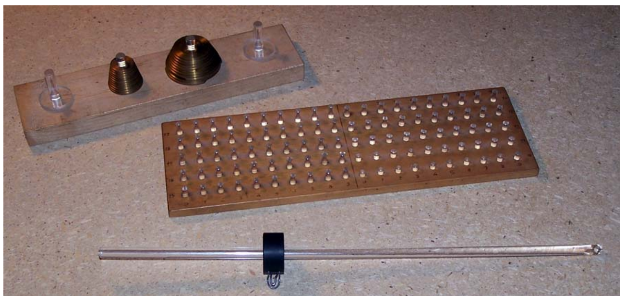
Figura 18. Calibrini per la misura del diametro interno della cameratura e anellini per le campane degli oboi
